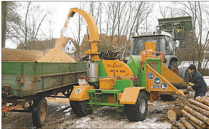
Hackschnitzel herstellen und diese dann verfeuern, um Wärme zu erzeugen. Die dafür nötigen technischen Anlagen stellt die Heizomat Gerätebau Energiesysteme GmbH aus Maicha bei Gunzenhausen her.
