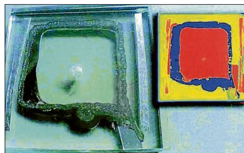
Vakuumverglasung ermöglicht eine sehr gute Wärmeisolierung. Die Herausforderung besteht darin, die Scheiben so gut abzudichten, dass das Vakuum im Inneren über Jahrzehnte bestehen bleibt. FOTO EMPA
