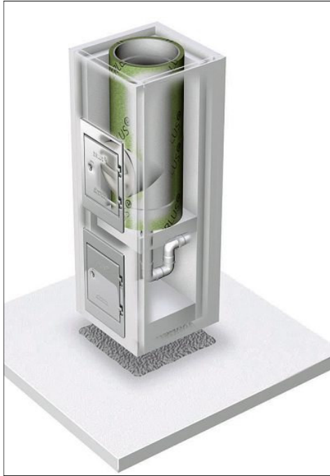
Der Fertigfuß des Edelkeramik Leichtbauschornsteins LC. FOTOS ERLUS AG
