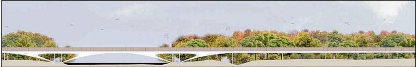
Der Siegerbeitrag (oben) der Ingenieurgruppe Bauen überzeugte das Preisgericht mit einem schlanken Brückenentwurf in Stahlbetonbauweise. Der mit dem 2. Preis ausgezeichnete Beitrag der SSF Ingenieure AG (links) sieht einen Verbundplattenbalken mit luftdicht verschweißten Hohlkästen aus WT-Stahl vor. Durch die Konstruktion des Überbaus als Stahlverbundträger über dem Flussfeld und als Spannbeton-Plattenbalken im Vorlandbereich nutzt der mit dem 3. Preis ausgezeichnete Beitrag des Ingenieurbüros Grassl die Vorteile beider Bauweisen.
