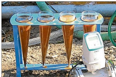
Kontrolle des Trübstoffaustlags.
