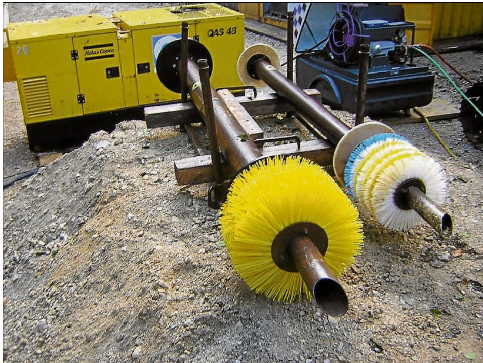
Mechanische Brunnenregenerierung mit Bürsten-Kolben-Kombination.
