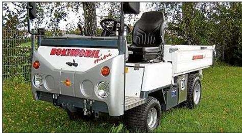
Das Fahrzeug verfügt über 1,5 Tonnen Nutzlast.
