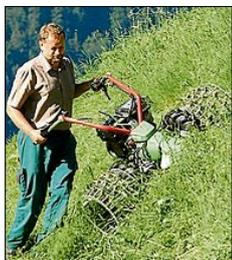
Selbst bei Hangneigungen von bis zu 120 Prozent mäht der Rapid Ex noch zuverlässig. FOTO: BSZ
