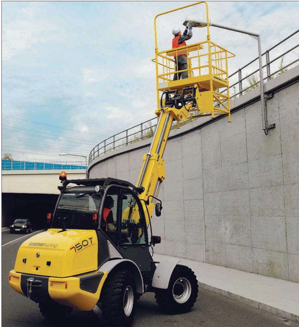
Mit dem Kramer Radlader sind Arbeitshöhen bis zu 7 m möglich.
