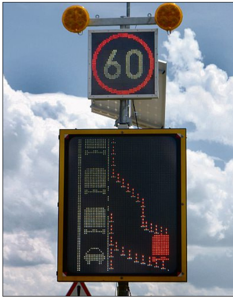
Je nach Verkehrssituation informieren die dynamischen Anzeigetafeln der B.A.S. Verkehrstechnik AG aus Hemmingen die Autofahrer, was an der Baustelle auf sie zukommt.
