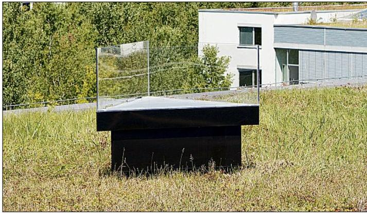
Mit dieser Schneewaage wird gemessen, ob die Last für das darunter befindliche Dach zu groß wird. Sollte dies der Fall sein, wird Alarm ausgelöst.
