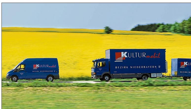
Das KULTURmobil ist ein 7,5-Tonner-LKW mit Kastenaufbau, der sich durch Aufklappen der Seitenwand in eine Bühne verwandelt lässt.
