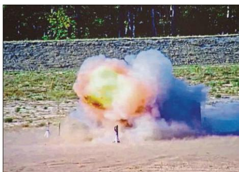
Vorbereitung zur Sprengung: Im Auftrag des Bundesamts für Bevölkerungsschutz und Katastrophenhilfe (BBK) werden auf dem „Testgelände Technische Sicherheit“ der Bundesanstalt für Materialforschung und -prüfung (BAM) in Horstwalde im Süden von Berlin Pflanzen auf deren Schutzmöglichkeiten vor Bombenattentaten getestet. Die rosa Kugel enthält den Sprengstoff. Nach der Zündung macht es gewaltig bumm.
