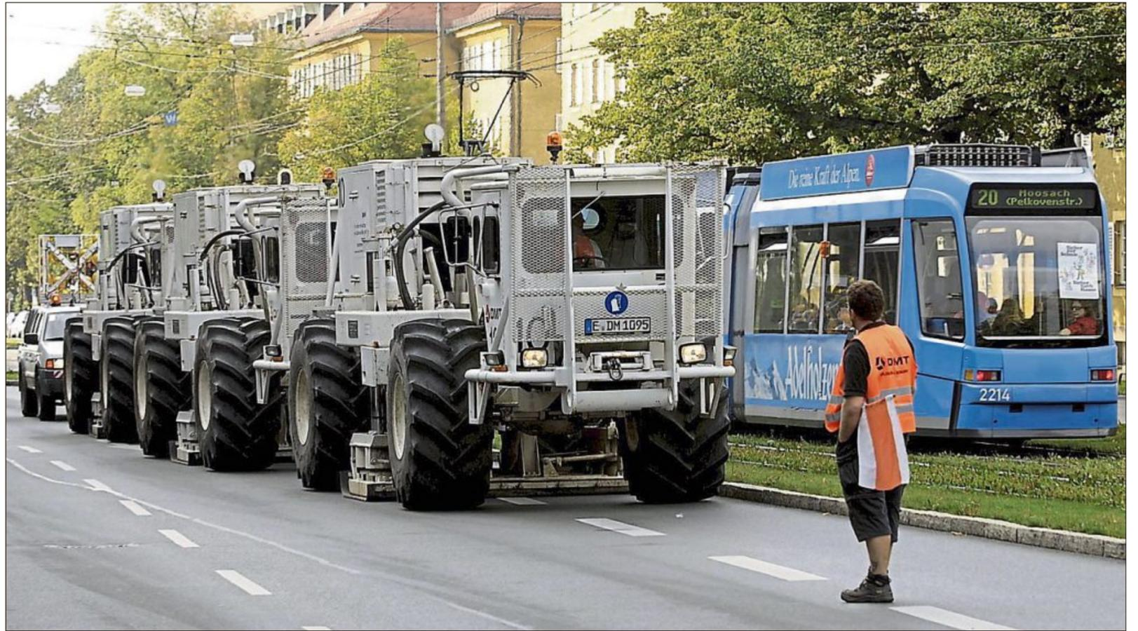
Mit Messfahrzeugen wurde 2015 in München und Umgebung nach unterirdischem Heißwasser für die Nutzung von Erdwärme gesucht.
